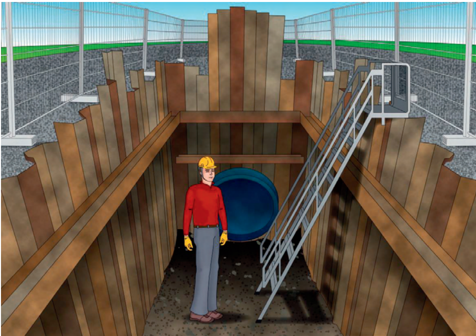
Figura 4 - Sistema realizzato mediante palancole con scala per effettuare la discesa
